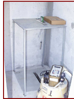
Estación de aforo, limnógrafo y muestrador automático de aguas
